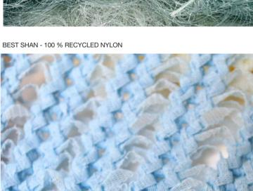
Les fournisseurs intègrent les déchets de fibres post-consommation, de filets de pêche en nylon et des bouteilles en plastique dans les processus de filature. Les filateurs intègrent des procédés de numérisation de logos pour vérifier les niveaux de stock, ainsi que des certifications liées au développement durable, à la traçabilité et aux normes de qualité.
